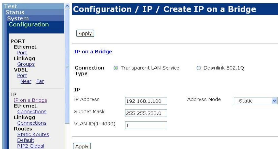
②IP アドレス、サブネットマスク、VLAN ID を入力し、「Apply」ボタンを押します。
