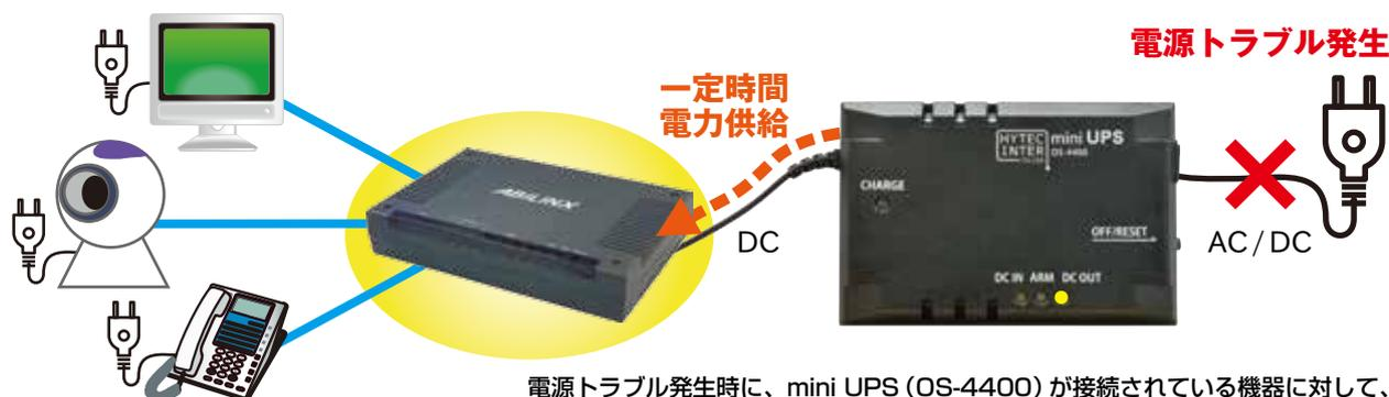
電源トラブル発生時に、mini UPS (OS-4400) が接続されている機器に対して、一定時間電力を供給します。
