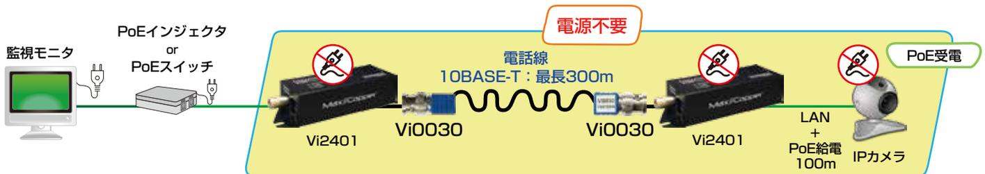
Vi0030は、MaxiiCopper 2400シリーズ（同軸ケーブルPoE延長装置）に接続することで、最長300mまで電話線でのPoE延長が可能になる、同軸→電話線変換コネクタです。軽量・コンパクト設計で、設置場所を選びません。電話線を使用して、低価格で300mまでPoE延長したい方に最適です。
