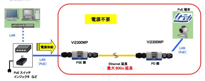
図に示す各LANケーブル長は最大100mまで使用可能ですが、PoE給電機器とVi2300WP(PSE側)をつなぐLANケーブルは、伝送性能やPoE電力給電機能に影響を与える可能性が大きい為、出来るだけ短いケーブルを使用することを推奨いたします。
