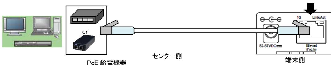
3. 最後に PoE 給電機器の電源を投入してください。
