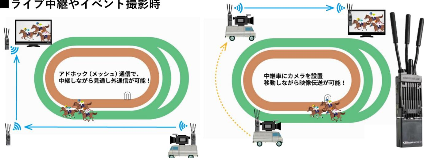
電波干渉がなく半径5kmの見通しで安定した映像伝送が可能。通常の無線伝送と異なり、アドホック（メッシュ）通信で、中継しながら見通し外通信を実現します。
