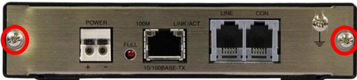
ある程度ネジを緩めると背面パネルと基盤が簡単に抜き取れます。
