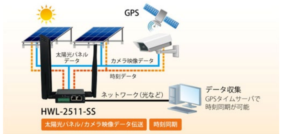
ソーラー施設のデータ及びカメラ映像の収集での利用事例
