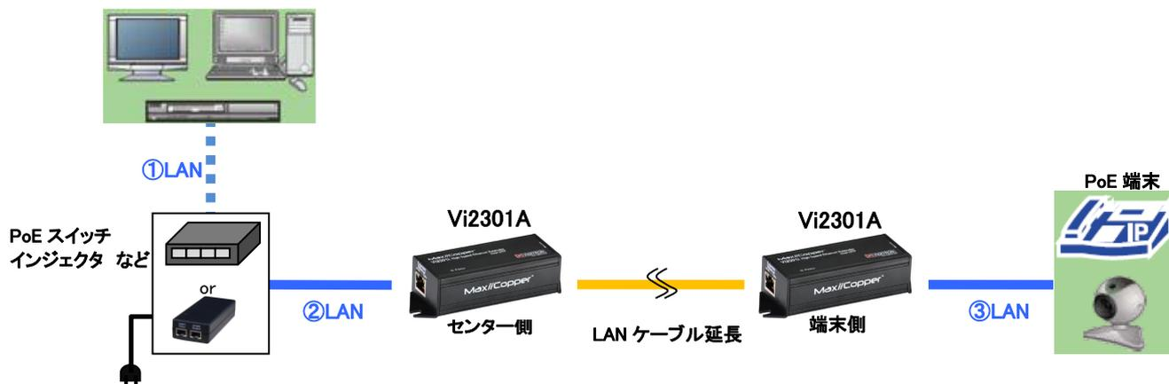
図に示す各LANケーブル長は最大100mまで使用可能ですが、PoE給電機器とセンター側Vi2301Aをつなぐ②LANケーブルは、伝送性能やPoE電力給電機能に影響を与える可能性が大きい為、出来るだけ短いケーブルを使用することを推奨いたします。
