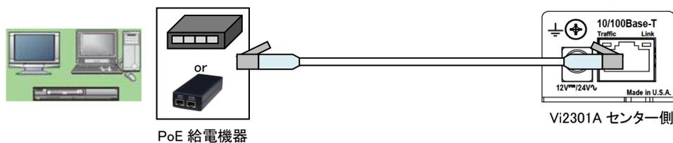
4. 最後に PoE 給電機器の電源を投入してください。
