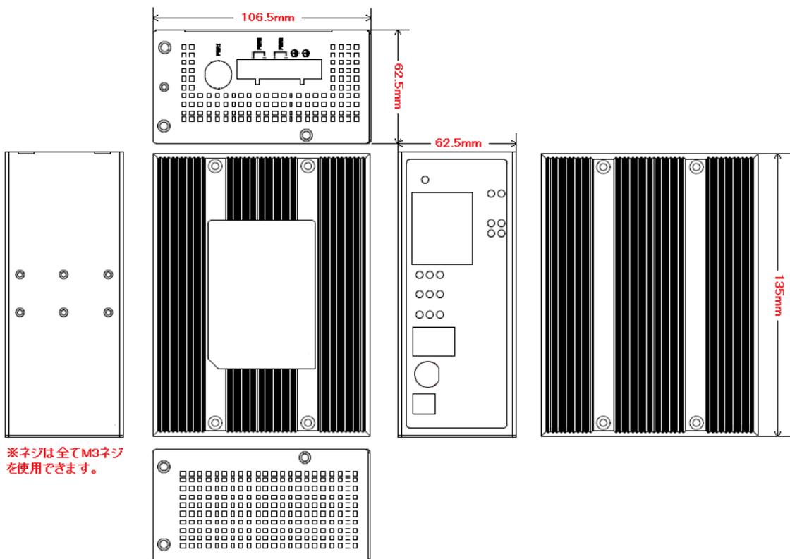
**ABiLIX 3101T/R-V2 DIN レール取付金具装着時**
