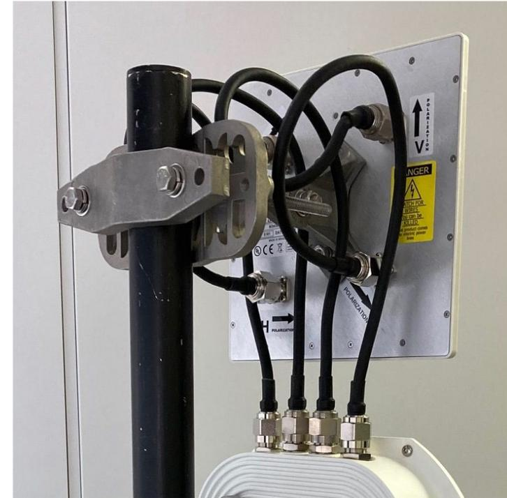
MO10の上側にある4つのアンテナ端子をパネルアンテナの4つの端子に同軸ケーブルでそれぞれ取り付けます。MO10側のアンテナ端子とパネルアンテナ側アンテナの端子の接続に決まった組み合わせがありませんので、それぞれの取り付けやすい端子に4本の同軸ケーブルで取り付けてください。
