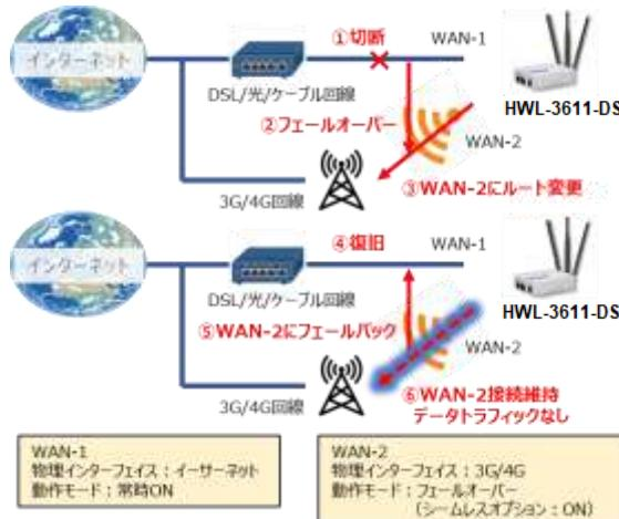
シームレスオプションを ON に設定すると、副回線である WAN-1 と同じく WAN-2 も同時に接続を開始します。この時に WAN-2 でデータの送受信は行われません。WAN-1 が切離されたときに、WAN-2 のデータ送受信を開始します。WAN-1 復旧時にはデータ送受信が WAN-1 側に移行しますが、WAN-2 は接続を維持します。このように、WAN-2 のバックアップ接続動作が無い分フェールオーバーにかかる切り替え時間が短縮できます。
