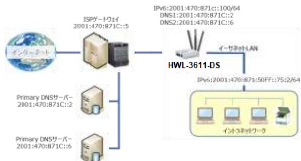
左図は、IPv6 の IP アドレッシングを示しています。IPv6 ネットワークを設定するために ISP から提供された情報を入力します。
