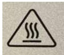
注意: **金属製ケースの表面温度は、非常に高くなる恐れがあります。**特に長時間動作させた後、空調のない閉じたキャビネットに設置した場合や周囲温度が高い空間に設置した場合は注意してください。
