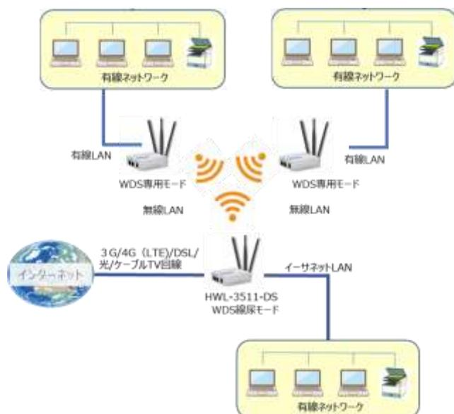
WDS (Wireless Distributed System) 専用モードでは、複数のゲートウェイ機器 (HWL-3611-DS のような) が WiFi ネットワークで相互通信を行い、有線ネットワークの拡張を行うことが可能となります。WDS 専用モードで構築された WiFi ネットワークには、WiFi ステーション (WiFi 対応 PC/スマートフォン/タブレット/ネットワークカメラなど) を直接接続することができません。
