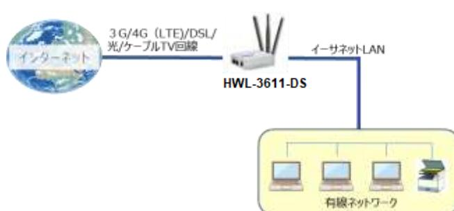
ローカルエリアネットワーク(LAN)を使って、ネットワークに接続されたコンピュータ間で、データまたはファイルを共有することができます。左の図は、コンピュータやプリンターをケーブルで接続するネットワークの代表例です。
