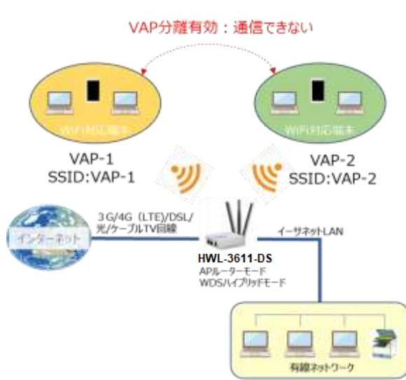
仮想 AP (VAP: Virtual Access Point) は、ワイヤレスネットワークを複数のドメインに分割する機能です。1つの物理 AP に 2つの AP が動作しているようにネットワークを構築できます。各 VAP に対して、Wi-Fi クライアントアクセスを制御するために SSID、認証、暗号化を設定する必要があります。
