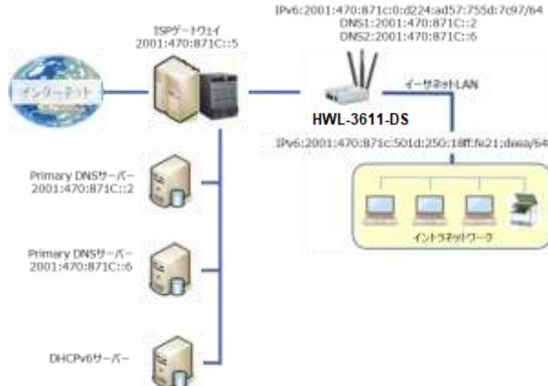
IPv6 アドレスの更新のためにサーバーに再接続する時刻を送信します。クライアントは、IPv6 アドレスを更新する要求を再送信する必要があります。左図は、DHCPv6 IP アドレッシングを示します。ISP の DHCPv6 サーバーが、IPv6 アドレス、IPv6 デフォルトゲートウェイアドレス、および、IPv6 DNS をクライアントホストに自動的に割り当てます。
