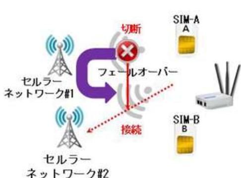
通常は優先された回線を使用します。回ネットワーク監視構成の条件を満たしたり、SIM 転換のポリシーで設定された条件を満たしたりしたときに、もう一回線へ切り替えます<sup>(\*)</sup>。このモードの場合 SIM-A/SIM-B の回線は交互に使用されますが、優先順位の高い SIM にスイッチバックすることはできません。
