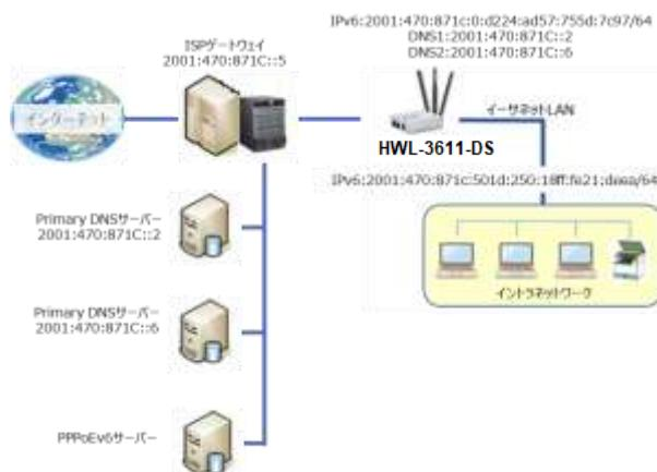
レス、DNS サーバーアドレス、および、その他の必要なパラメータを送信し、クライアントを自動的に構成します。左図は、PPPoE による IPv6 アドレッシングを示しています。ISP 側の PPPoEv6 サーバーは、PPPoEv6 クライアントからの要求を受信すると IPv6 構成を提供します。PPPoEv6 サーバーが、クライアントからの要求を取得し、正常に認証すると、サーバーは、IP アドレス、DNS サーバーアドレス、および、
