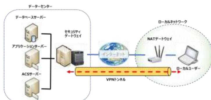
アドレス変換機能(NAT)が動作している場合、ローカルエリアネットワークに接続されたローカルユーザーが、直接外部のセキュアネットワークにアクセスするための VPN トネリングを構成することはできません。本機は、VPN パススルー機能
