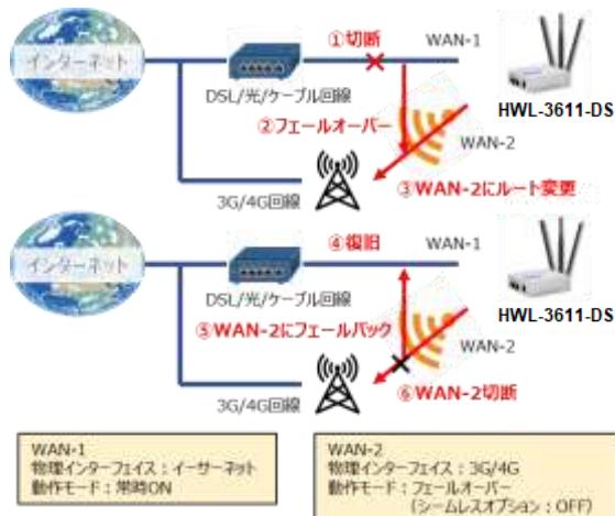
フェールオーバーに設定した WAN-2 は WAN-1 のバックアップ接続です。これは主インターフェイスの WAN 接続が切断されたときのみ、切離していた WAN-2 によるバックアップ接続が行われ通信を継続します。次に、WAN-1 が復旧すると、WAN-2 から WAN-1 にフェールバックして WAN-2 を切離します。
