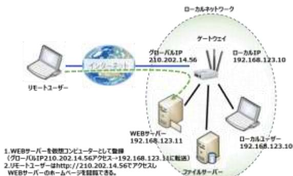
を全て特定のローカルネットワーク内のサーバーなどIP機器(仮想コンピュータ)1台のみに転送する機能です。本機能は固定グローバルIPアドレス契約などの環境で使用します。WAN ポートでなくグローバルIPアドレスが条件となる点が、後述の DMZ 機能との違いになります。
