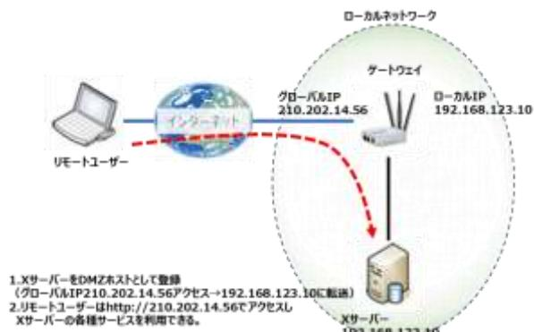
X サーバーをローカルエリアネットワークに配置した場合、リモートユーザーがサーバーからのサービスを要求する場合には、このサーバーを DMZ ホストとなるように設定する必要があります。左図はリモートユーザーがグローバル IP210.202.14.56 のゲートウェイにアクセスすることで X サーバーからサービスを要求することができます。
