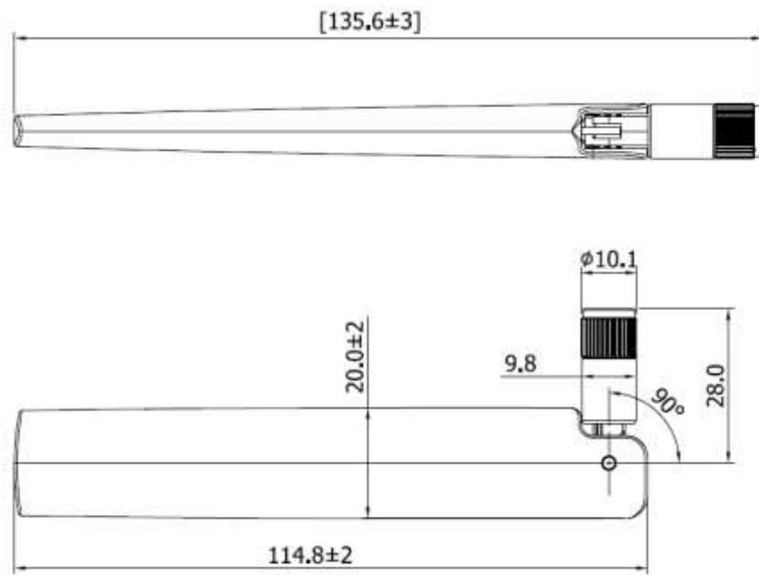
＜寸法図＞ Wi-Fi アンテナ
