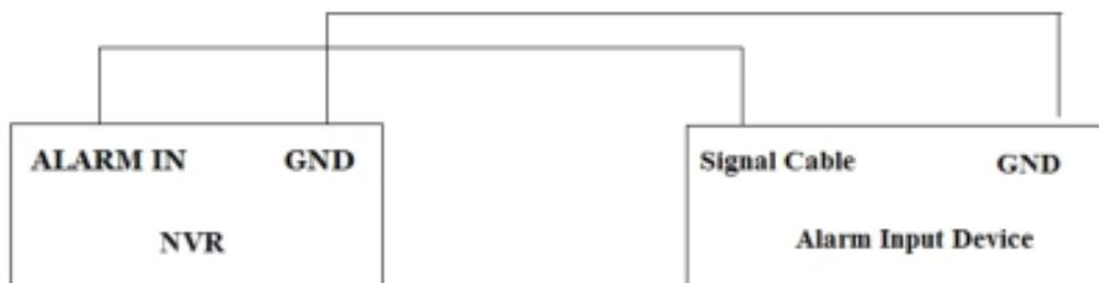
アラーム入力はオープン/クローズリレーです。入力がオープン/クローズリレーでない場合は、次の接続図を参照してください。
