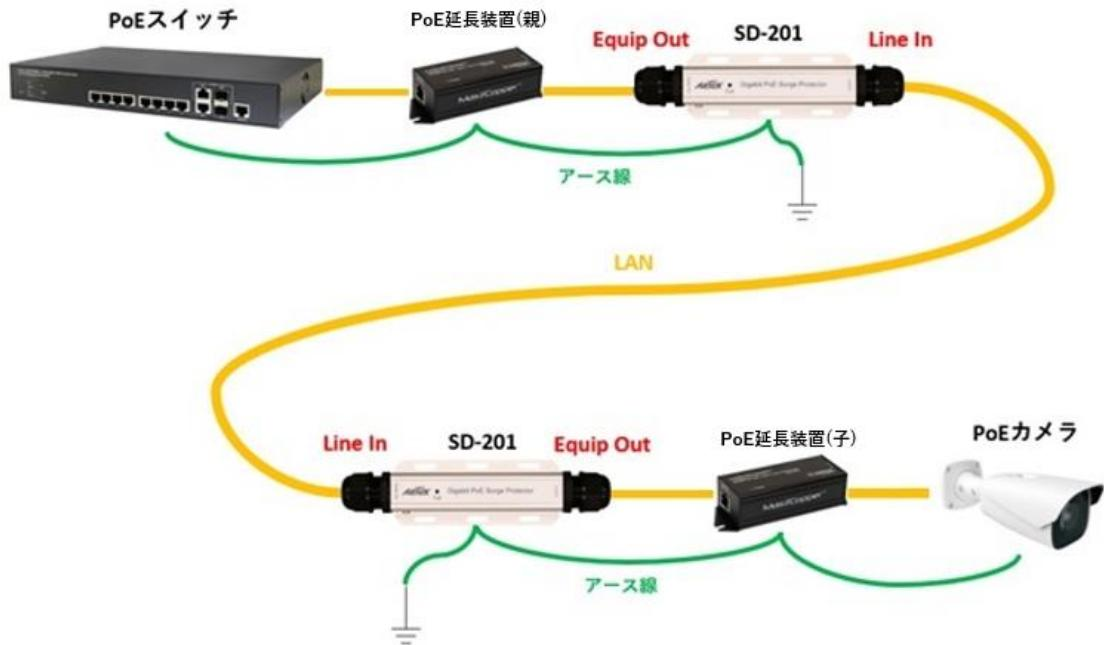
※LAN の長さは PoE スイッチ～延長装置(親)100m 以内、延長装置(子)～カメラで 100m 以内ですが各機器間は可能な限り短く接続することを推奨いたします。
