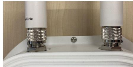
3. 各アンテナの接続部分は下の左側の図のように自己融着テープで防水加工をすることを推奨します。なお、自己融着テープは紫外線で劣化しやすいため、下の右側の図のようにビニールテープで被覆します。アンテナ 4 本側は 4 本のアンテナを取り付けた状態ではテープを巻きにくいため、アンテナを 1 本づつ取り付けながらテープを巻くようにしてください。
