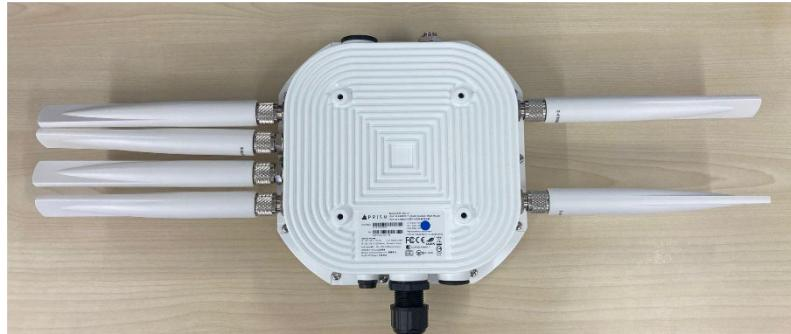
2. アンテナ 4 本側は、下の左側の図のようになるまでアンテナを回しながら取り付けます。同様にアンテナ 2 本側は下の右側の図のようになるまでアンテナを回しながらとりつけます。斜めに多少ずれた状態で取り付けると正常な通信ができなくなります。
