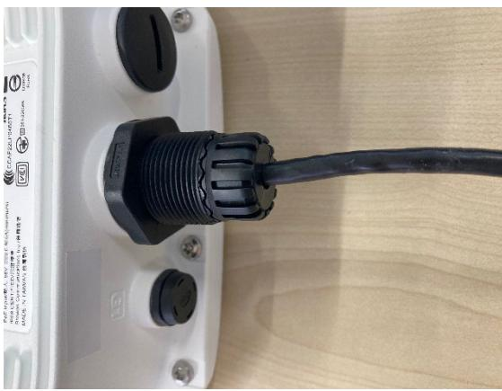
8. 最後にキャップ④を取り付けて、ゴムパッキン②が多少膨らむ程度まで締め付けます。締め付けすぎると LAN ケーブルを傷つける可能性があります。
